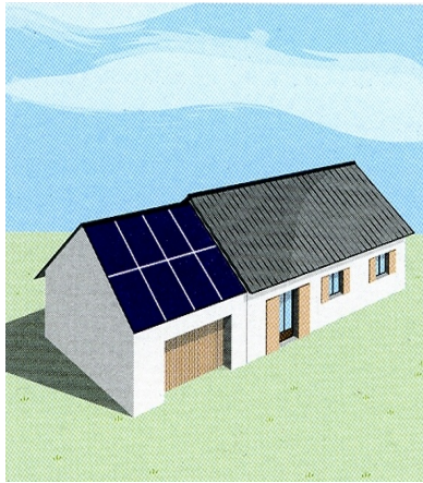
Les capteurs couvrent la totalité de la toiture du garage
